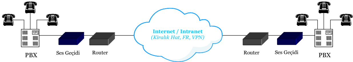
Şekil 2. - Tipik IP telefon sistemi
